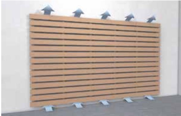
Der Hinterlüftungsabstand muss mindestens 20 mm betragen und darf nicht verengt werden. Die Hinterlüftung aus thermischem Antrieb muss gewährleistet sein. Für den Mindestlüftungsquerschnitt der Unterkonstruktion unbedingt die gängigen Normen beachten und einhalten. (z. B. DIN 18516-1). Bei einer horizontalen Traglattung empfiehlt sich eine vertikale Grundlattung (Konterlattung).
