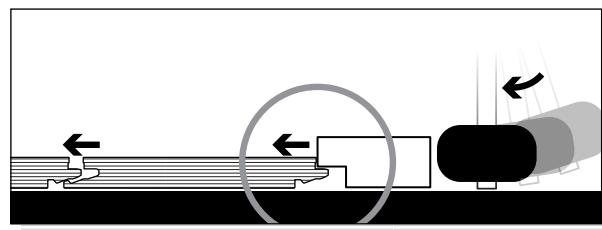
**DE** Option 2: Mit dieser Option können die Paneele zusammengefügt werden, ohne diese anzuheben oder im entsprechenden Winkel zu bewegen. Diese Vorgehensweise wird dann empfohlen, wenn das Verlegen nach Option 1 nicht uneingeschränkt möglich ist.
