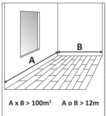
**DE** Bei Oberflächen über 100m<sup>2</sup> oder Längen über 12m sollten dennoch zusätzliche Dehnfugen vorgesehen werden. Die Dehnfugen können mit einem Element aus unserem breiten Angebot an Zubehör verkleidet werden.
