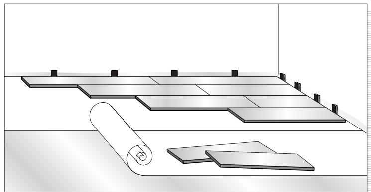
**DE** Wenn Sie sich dazu entschieden haben, eine Isolierschicht als Untergrund zu verwenden, müssen Sie als erstes das Grundmaterial gleichmäßig verteilen und es an den Wänden leicht hoch steigen lassen. Nachdem Sie den Boden verlegt haben, können Sie dann das überstehende Material entfernen und es mit Fußleisten verkleiden.
