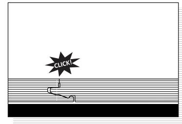
**DE** Option 1: Hierbei handelt es sich um die einfachste und am häufigsten angewandte Verlegetechnik. In den meisten Fällen ist sie auch die optimale. Das Panel wird quer am Boden in einem Winkel von 20° bis 30° zum zuvor verlegten Panel angebracht. Dabei wird es nach oben und nach unten bewegt und gleichzeitig nach vorne gedrückt, dadurch entsteht zwischen der Nut und Feder eine feste Verbindung.
