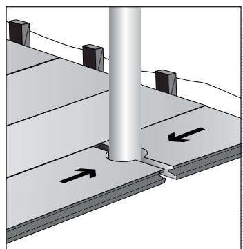
**DE** Rohrleitungen: Sollten sich in dem besagten Raum Rohrleitungen befinden, die umgangen werden müssen, achten Sie darauf, dass diese immer genau zwischen zwei Paneele liegen. Bohren Sie ein Loch mit einem der Leitung entsprechenden Durchmesser plus zusätzlichen 20mm.
