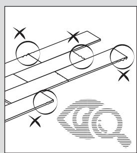
**DE** Jegliche RESOPAL® Produkte werden sorgfältig auf Qualität geprüft, kontrollieren Sie dennoch alle Paneele vor und während dem Verlegen, um ggf. beschädigte Stücke auszusortieren.
