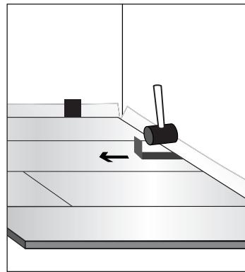
**DE** Behalten Sie diese Methode bis zur letzten Reihe bei. Beachten Sie, dass Sie hier nun auch den Abstand einer Dehnfuge zwischen Paneel und Wand lassen müssen. Für die Verbindung der letzten und vorletzten Reihe verwenden Sie einen geeigneten Hammer, um gemäß der "Option 2" vorzugehen.
