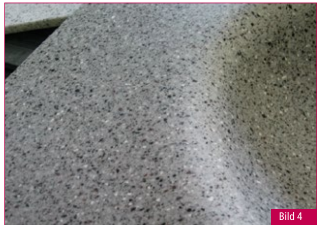
Bild 4: 2D Kleiner Radius mit Weißfärbungseffekt durch dunklere Farbgebung.
